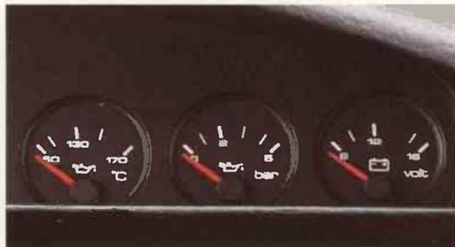
Voltmètre, indicateurs de pression et de température d'huile.
