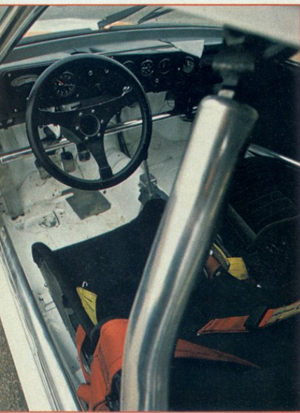
L'arceau de sécurité constitue un véritable châssis tubulaire sous la coque.
