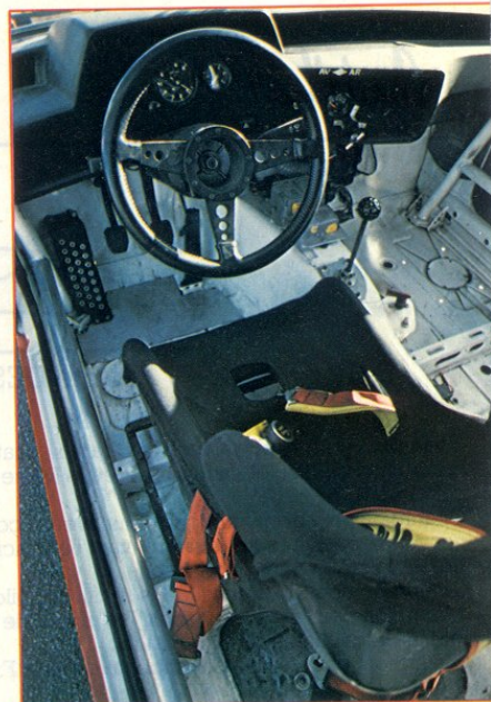
La 635 Production est montée à partir d'une coque Gr. A commercialisée par BMW Motorsport.
